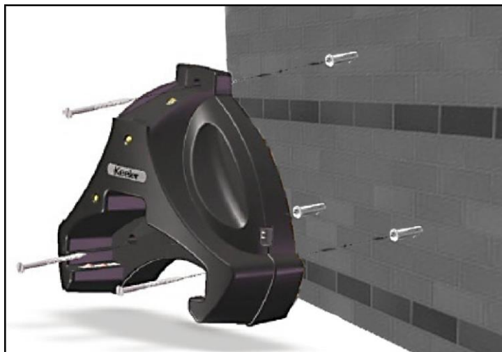
Figura 6-15 Schema de referință pentru montajul stației de încărcare a acumulatorului
