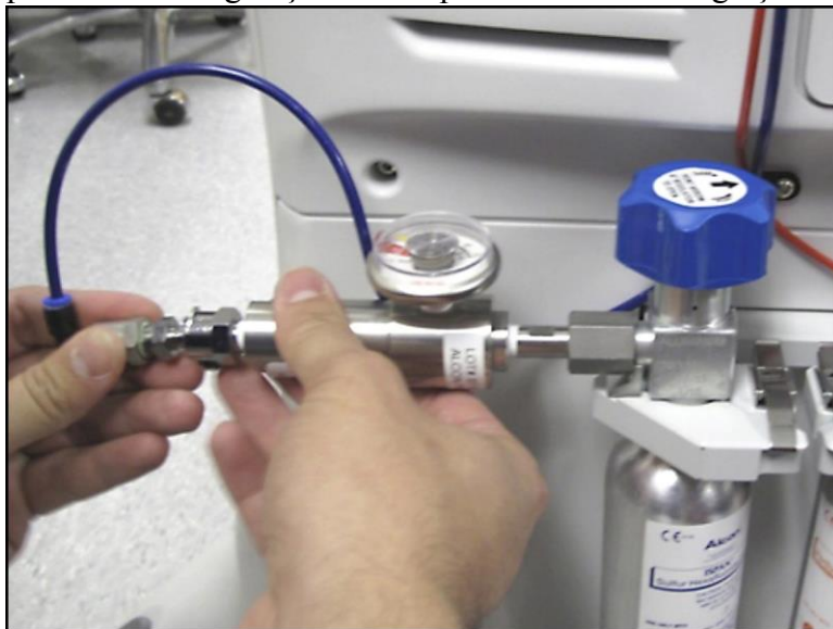
Figura 3-10 Fixarea fittingului cu racordare rapidă
