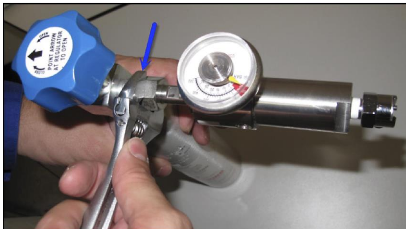
Figura 3-7 Racordarea dispozitivului de reglare SF 6 la flaconul de gaz SF 6
