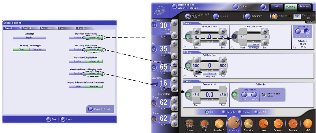
Figura 2-65 Modurile de afișare standard versus avansat: modul standard asigură comenzile de bază necesare pentru fiecare pas chirurgical; modul avansat asigură comenzile suplimentare ce permit utilizatorului să utilizeze toate capacitățile sistemului oftalmologic Constellation* .
