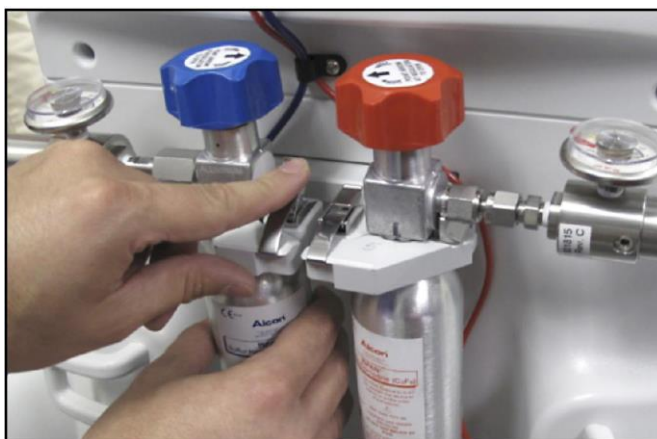
Figura 3-9 Fixarea ansamblurilor flacon/ dispozitiv de reglare la partea din spate a sistemului
